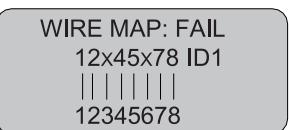
Строка «R» - «X» напротив «3» и «6» обозначает обрыв линии на дальнем конце кабелей, подключенных к разъемам 3 и 6, причем он расположен вблизи дальнего конца. Обрыв расположен в пределах 10% длины кабеля, измеренной от дальнего конца.
