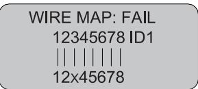
В строке «M» на месте «3» отображается «X», что значит наличие обрыва на ближнем конце у контакта «3». Обрыв расположен в пределах 10% длины кабеля, измеренной от ближнего конца.
