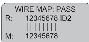
Тестирование STP кабеля прибором LAN-PRO-L/TPK-N-8R при использовании удаленного идентификатора.
