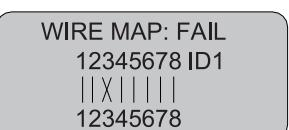
Вместо «1» между «3» отображается «X», что значит наличие обрыва в средней части кабеля на контакте «3». Обрыв расположен на участке длины кабеля от 10% до 90%, если считать от ближнего конца. Для более точного обнаружения места обрыва можно воспользоваться функцией измерения пары и длины (PAIR & LENGTH), как описано ниже.
