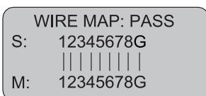
Тестирование STP кабеля прибором LAN-PRO-L/TPK-N-8R порт MAIN+ порт SCAN RJ45
