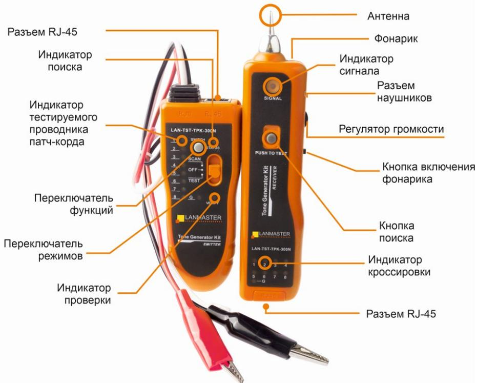
Тестовый набор предназначен для идентификации и отслеживания (трассировки) проводов и кабелей в пучках без разрушения изоляции. Состоит из двух приборов передатчика (EMITER) и приемника (RECEIVER). Набор применяется при монтаже, тестировании и обслуживании компьютерных, телефонных и электрических сетей.
